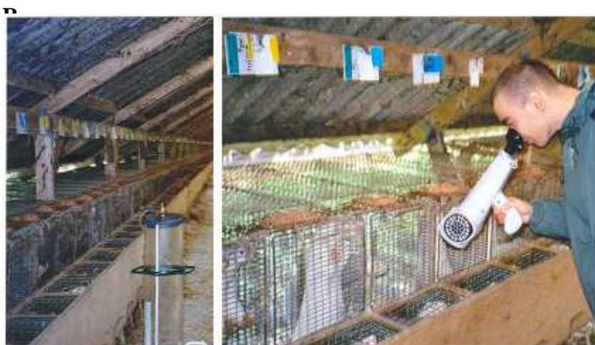
Rys. 1. Cylinder gazowy stosowany podczas pobierania próbek i uczestnik pomiarów z olfaktometrem Nasal Ranger
