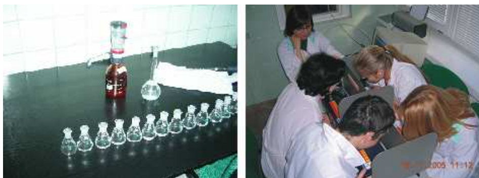
Rys. 2. n-Butanolowa skala intensywności zapachu oraz grupa oceniających przy olfaktometrze TO7
