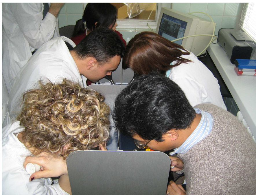
Rys. 2. Pomiar stężenia zapachowego metodą rozcieńczeń dynamicznych (PN-EN 13725)
