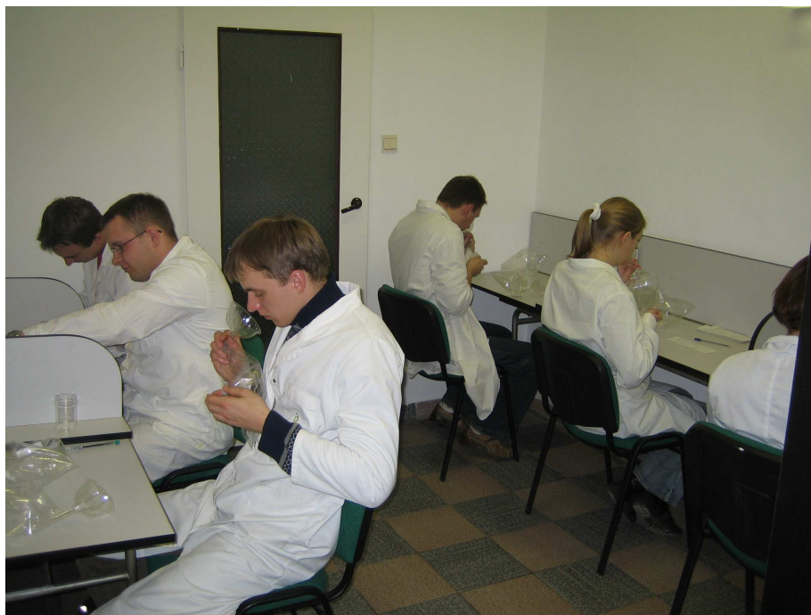
Rys. 3. Pomiar stężenia zapachowego metodą trójkątową (rozcieńczenia statyczne)
