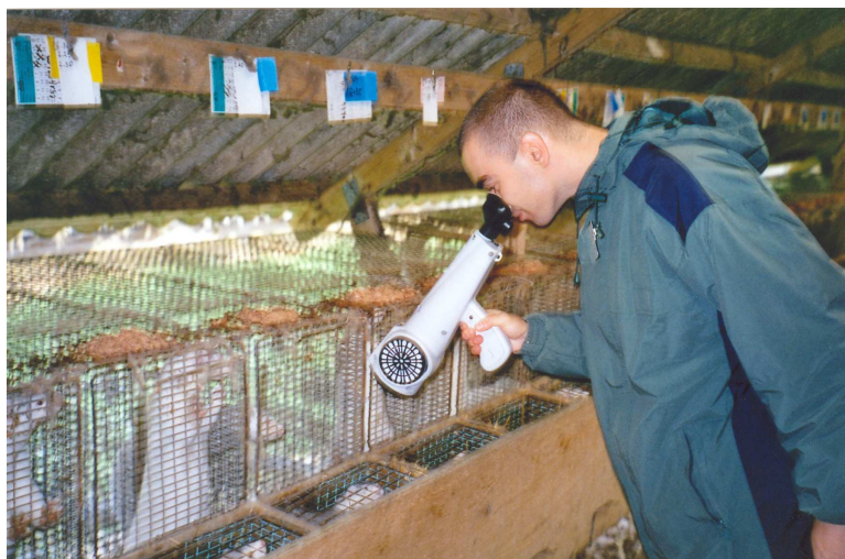
Pomiar stężenia zapachowego z użyciem olfaktometru Nasal Ranger
