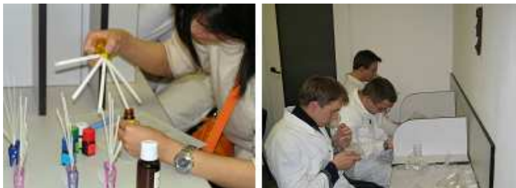
Rys. 3. Pomiar stężenia zapachowego metodą zalecaną przez japońskie Ministerstwo Środowiska (po lewej - przygotowanie próbek do testu sensorycznej wrażliwości, po prawej – studenci Politechniki Szczecińskiej podczas ocen zapachu japońską metodą trójkątową)
