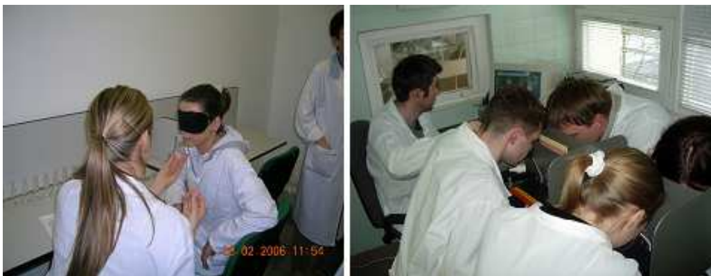
Rys. 2. Studenci Politechniki Szczecińskiej podczas testów węchowej wrażliwości na zapach n-butanolu (po lewej) i pomiaru stężenia zapachowego z użyciem olfaktometru dynamicznego TO7 (po prawej).
